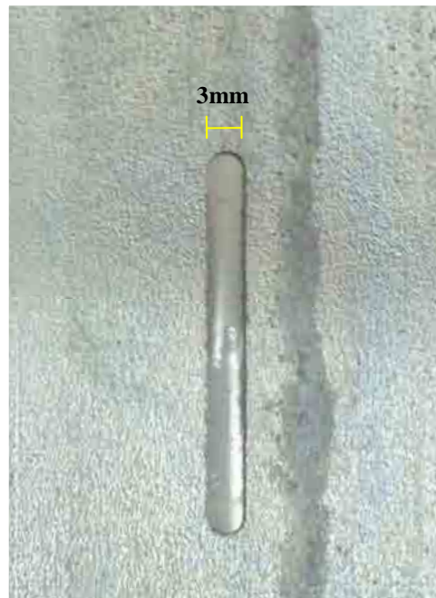
Fotografia 46 - Corpo-de-prova 12 - área exposta de 90mm 2 sem a presença de oxidação
