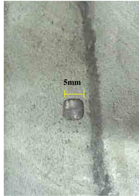
Fotografia 45 - Corpo-de-prova 11 - área exposta de 25mm 2 sem a presença de oxidação
