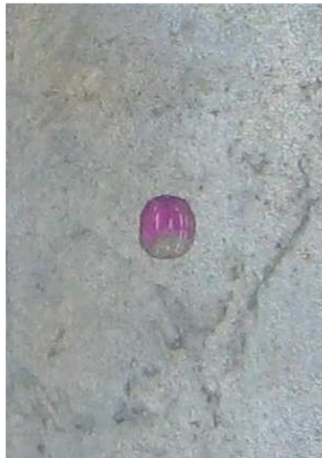
Fotografia 43 - Corpo-de-prova 9 - gota salina com ferricianeto de potássio e fenolftaleína
