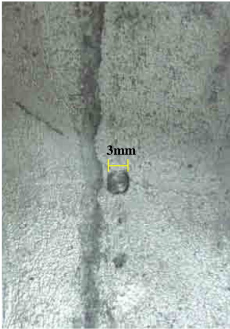
Fotografia 44 - Corpo-de-prova 10 - área exposta de 9mm 2 sem a presença de oxidação
