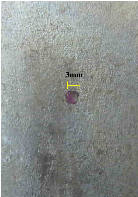
Fotografia 41 - Corpo-de-prova 7 - gota salina com fenolftaleína e ferricianeto de potássio
