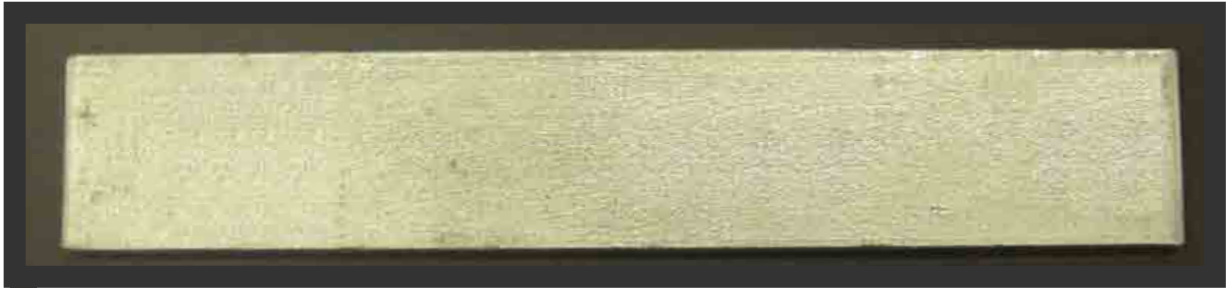
Fotografia 10 -Placa de aço 1020, zincada utilizada como padrão para os ensaios de corrosão
