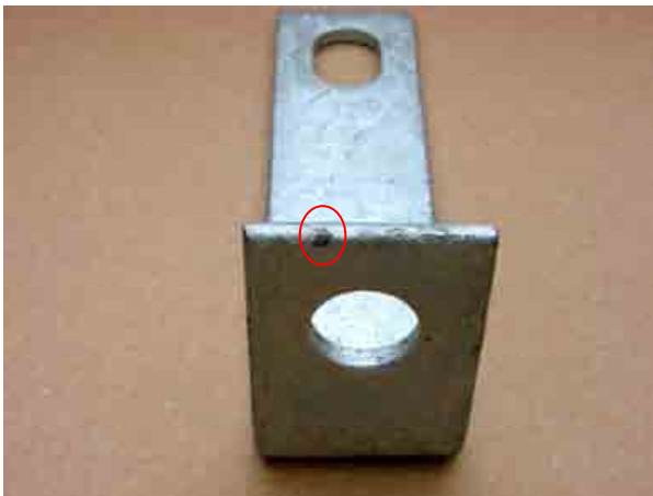
Fotografia 6 - Chapa "L", SAE 1010, apresentando deslocamento lateral e rejeitada por avaliação visual conforme norma ABNT NBR 6323
