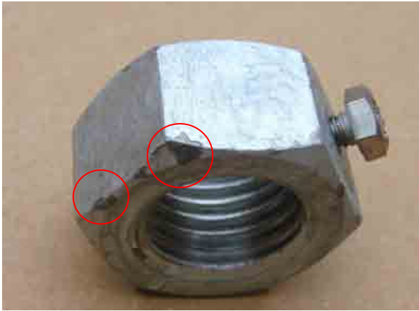
Fotografia 8 -Porca de aço SAE 1020, forjada, apresentando deslocamento, rejeitada por avaliação visual conforme norma ABNT NBR 6323
