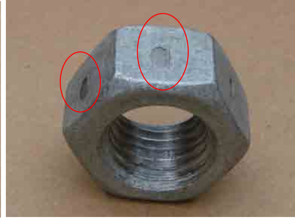
Fotografia 9 -Porca de aço SAE 1020, forjada, apresentando deslocamento após ensaio, rejeitada conforme norma ABNT NBR 7398
