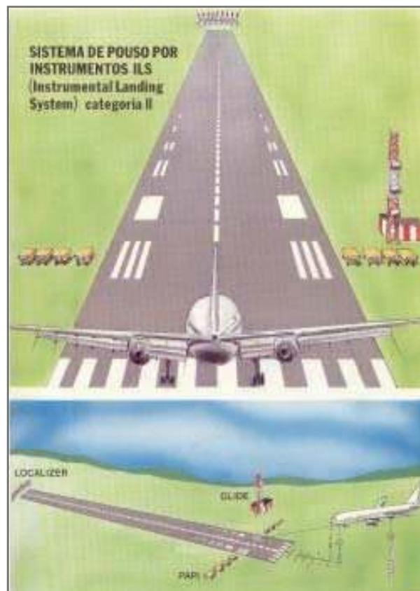
**Figura LII** – Sistema de Pousos por Instrumentos – ILS.
