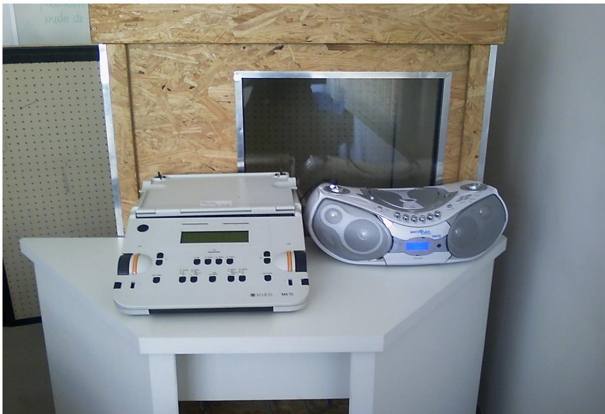
Figura 2 - Equipamento utilizado na coleta de dados: cabine acústica Vibrasom, audiômetro Maico MA52 e cd-player Bitrânia. Foto: Cláudia Ap. Valasek.
